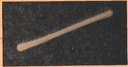
Fig 29 Bij vergroting van de luchtspleet tot 2 mm verandert de hysteresislus in een rechte lijn.
