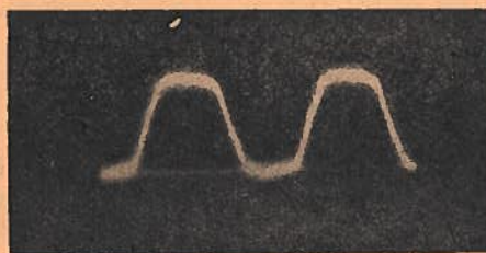
Fig 36 Laag frequente trilling na uitfiltering van restant van de hoog frequente trilling.
