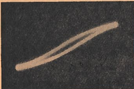
Fig 28 Hysteresislus van ijzerkern met kleine luchtspleet.
